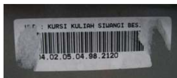
Gambar 5. Label Barcode Yang Rusak Dan Tidak Dapat Dibaca Scanner .
